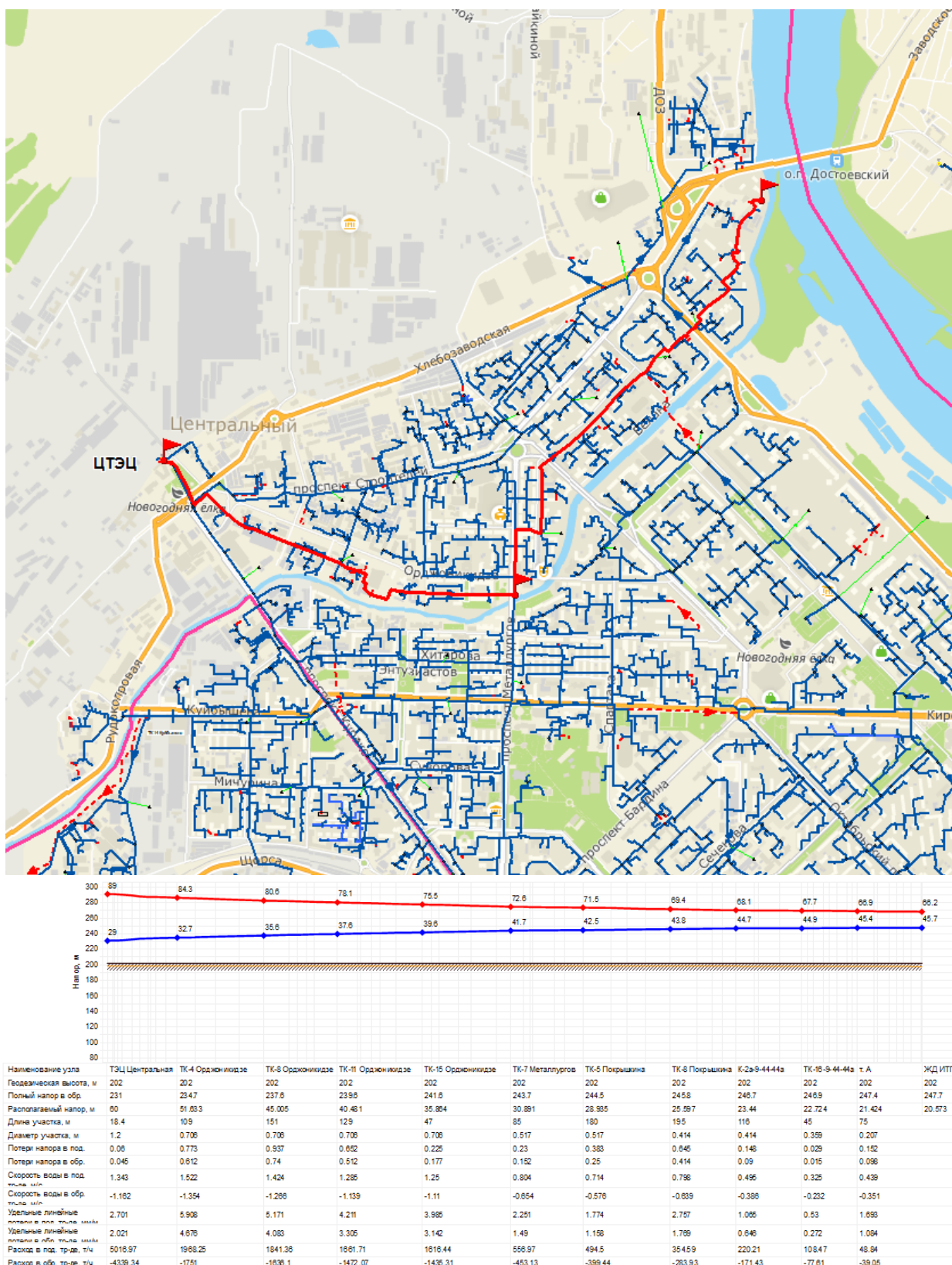
Рисунок 5.7 – Пьезометрический график магистрали ЦТЭЦ по ул. Орджоникидзе
